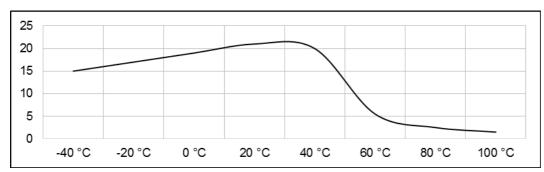
Vorbehandlung: Prüfkörper Aluminium gereinigt, geätzt. Aushärtung 4 Tage bei Raumtemperatur
