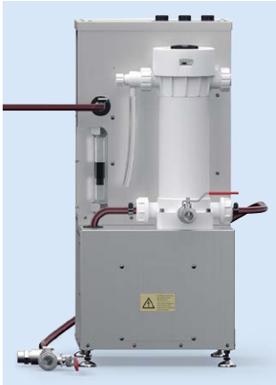
Der Elma Filter mit selbstansaugender Pumpe ist eine sinnvolle Ergänzung zur Filterung des Reinigungsbades und somit zur Verlängerung der Badstandzeit und Verringerung der Betriebskosten.
