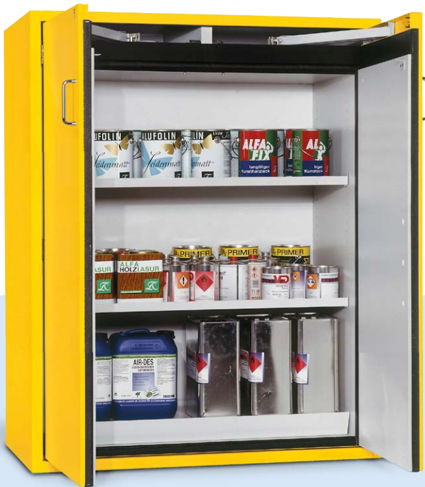
Gefährstoffschrank Edition-G Typ G-1200-F mit Einlegeboden, Bodenauffangwanne mit Lochblechabdeckung. Zweiter Einlegeboden ist optional.
