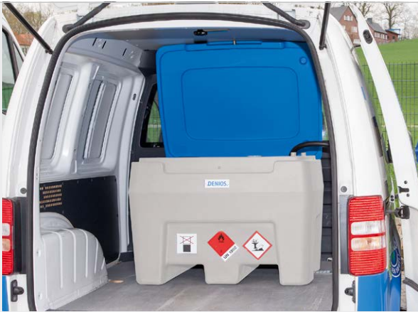
Die mobile Diesel-Tankanlage PolyMove mit 250 Liter Volumen passt auch mit geöffnetem Deckel in einen Kleintransporter. Die Schlauchlänge reicht, um komfortabel aus der Seiten- oder der Hecktür tanken zu können.
