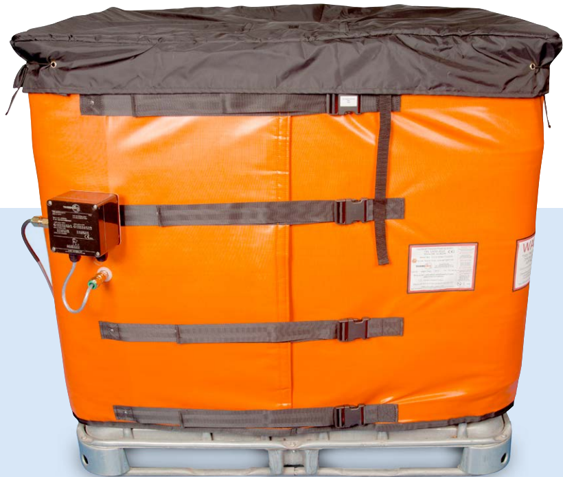
Ex-Heizmantel für 1000-L-IBC, mit analoger Temperaturregelung und Isolierhaube
