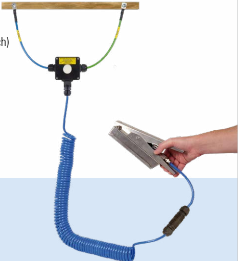
Typ C 52: 2-adrige Version - Prüfung und Anzeige, dass ein sicherer Kontakt am Behälter und zusätzlich am Erdungspunkt besteht.
