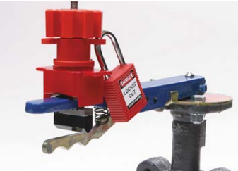
Verriegeln von Drosselventilen mit der Universal-Ventilabspernung: Der Haken wird am Griff des Drosselventils angebracht. Die Ventilstellung kann nicht mehr verändert werden.
