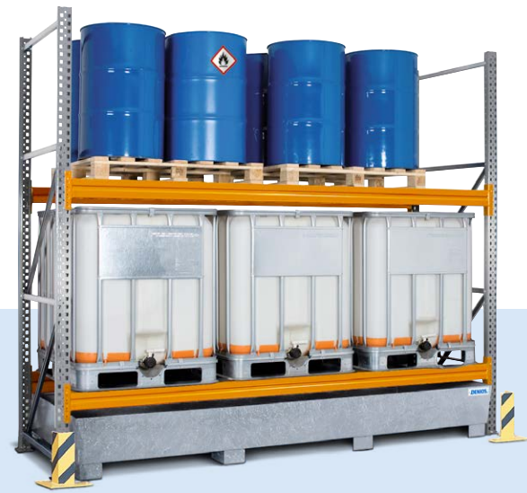
Gefahrstoff-Palettenregal mit 2 Lagerebenen, verzinkte Auffangwanne, Grundfeld (ohne Anfahrtschutzecken), Fachmaße (BxT) 3300 x 1100 mm
