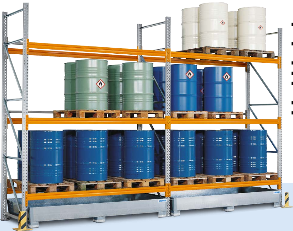
Gefahrstoff-Palettenregal mit 2 Lagerebenen, verzinkte Auffangwanne, Grund- und Anbaufeld (ohne Anfahrtschutzecken), Fachmaße (BxT) 2700 x 1100 mm
