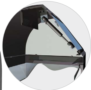
Einwurfsklappe mit Gasdruckfeder für geräuschloses Schließen; das abgerundete Kopfteil vermeidet, dass Abfall auf dem Behälter deponiert wird.
