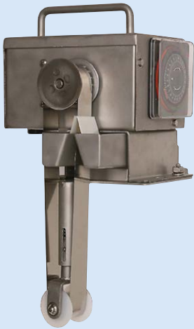
Tragbare Öl-Bandskimmer für flexiblen Einsatz an wechselnden Orten; das Öl wird beidseitig vom Band abgestreift.
