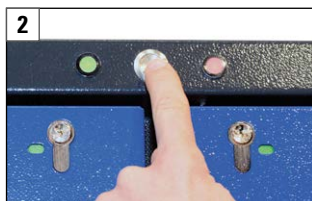
Funktionsanzeige (LED grün) und Warnleuchte (LED rot)
