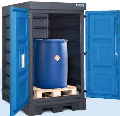
PolySafe Gefahrstoffdepot DL, für die Lagerung von bis zu 2 Fässern à 200 Liter hintereinander auf einer Europalette
