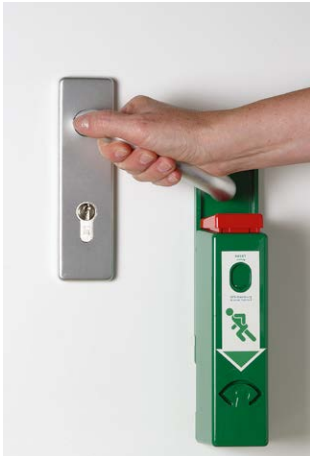
Beim Durchdrücken der Türklinke verschiebt sich der EH-Türwächter automatisch nach unten und ermöglicht mit nur einem Handgriff das Begehen der Notausgangstür. Dabei wird ein Daueralarm ausgelöst, der mit dem Geräteschlüssel gelöscht werden kann.
