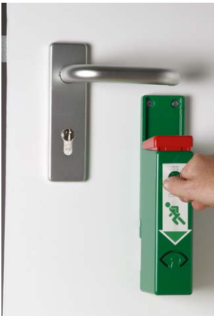
Mit dem Geräteschlüssel kann der Türwächter durch Verschieben nach unten alarmfrei in eine Dauer-Offen-Position gebracht werden. In dieser Position ist die Tür normal zu begehen.
