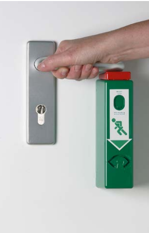
Druck auf den Türwächter löst den Voralarm aus. Mit dem Loslassen der Klinke verstummt der Alarm wieder.
