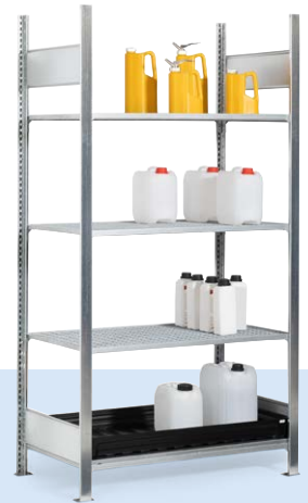
Gefahrstoff-Kleingebinderegal mit 3 Gitterrosten und Auffangwanne aus Kunststoff, Fachmaße (BxT) 1000 x 600 mm
