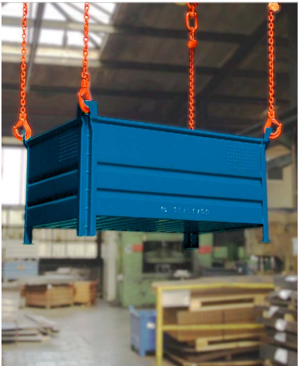
Stapelbehälter Typ Profi, ausgestattet mit 4 Kranösen für einfaches und sicheres Handling
