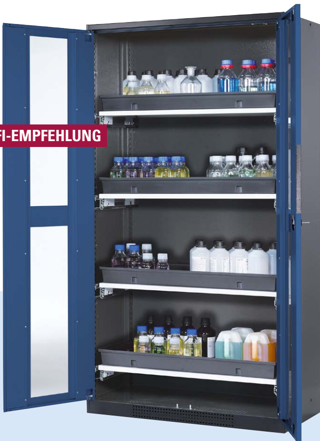
Größe und Anzahl der zu lagernden Gebinde sind ausschlaggebend für die Wahl Ihres Gefahrstoffschranks. Mit 4 Tablarauszügen (Typ 104) sind Sie flexibler bei den Gebindegrößen. Ein Nachrüsten mit separaten Tablarauszügen ist jederzeit möglich.
