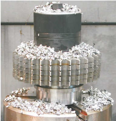
Spannmutter zur Klemmung von Kettenrädern bei der Fräsbearbeitung
