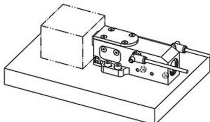
Seitliches Anschließen wie abgebildet. Untere Anschlüsse müssen verschlossen sein.
