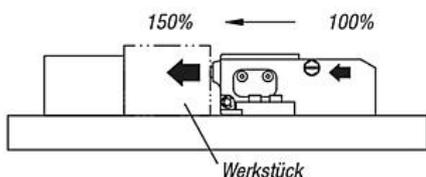
Der Spannarm wird über einen Keilmechanismus betätigt. Wenn der Luftdruck durch Luftleckage absenkt, verhindert der Keilmechanismus ein schnelles Absenken der Spannkraft.
