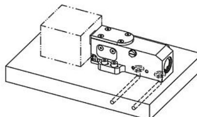
Anschluss von unten. Die seitlichen Anschlüsse müssen verschlossen sein.
