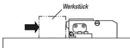
Keilmechanismus sorgt für sicheres Spannen, auch bei Gegenkraft gegen den Seitenspanner.
