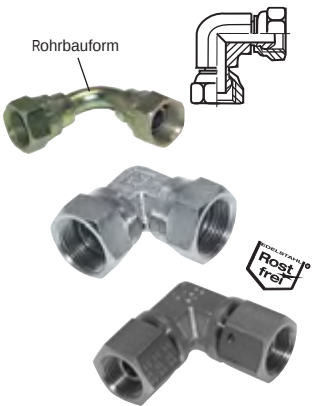
Winkel-Verschraubungen 90° mit G-Gewinde (60° Universaldichtkegel, innen) bis 575 bar
